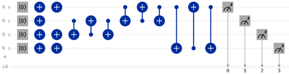
Figura 9: Diseño gráfico del circuito cuántico en IBM Quantum Composer para a = 7 y N = 15 . Las compuertas controladas C-NOT se hallan representadas por los símbolos \oplus y una conexión hasta el cubit de interés, mientras que la compuerta lógica NOT está dada por el símbolo \oplus sin conexiones. Las últimas componentes hacen referencia a la medición de cada cubit.
