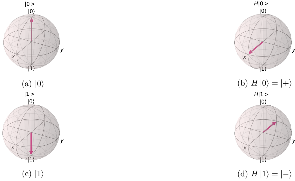
Figura 3: Efectos de la compuerta Hadamard sobre la base de qubits visualizados en la esfera de Bloch
